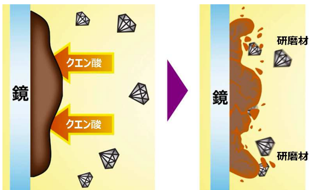
図：ウロコ・水アカ汚れ落としのメカニズム
