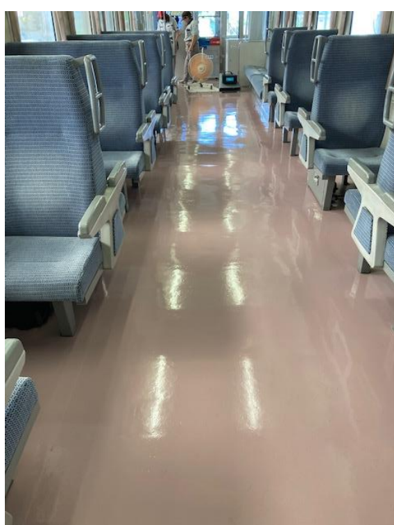
▲ FPC プロテクションコート3層 塗布後のフロア
