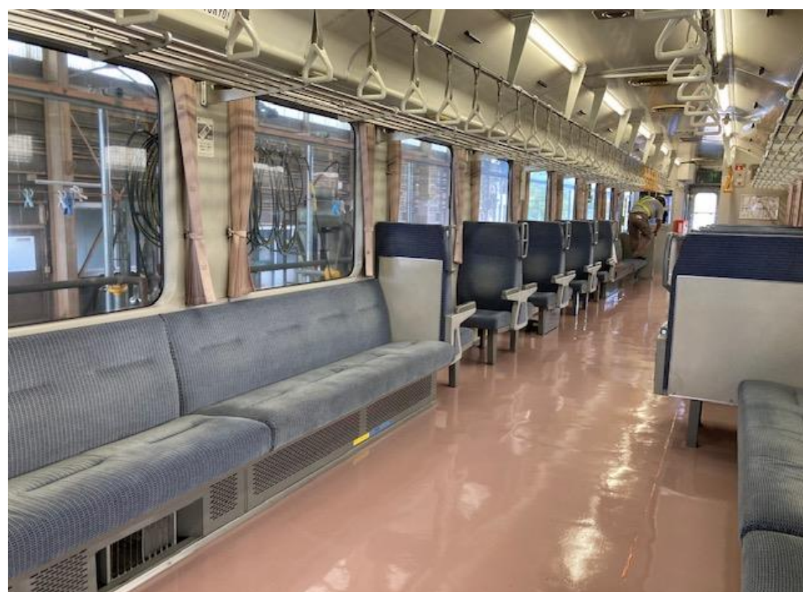
▲ 3層塗布後、光沢計の数値は77～81に上昇、照明が写り込んでいます
